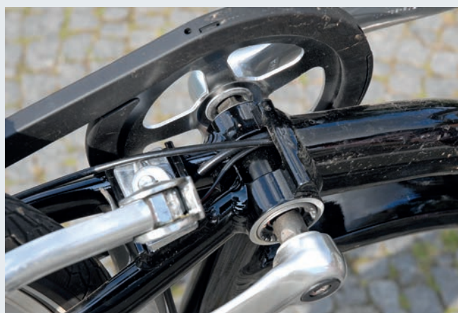
Všechny dráty, bowdeny a lanka vedou hned dovnitř rámu
